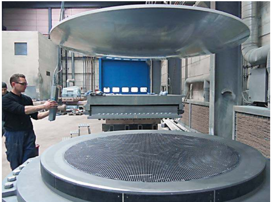
Apoio Esférico MAURER com carga vertical de 220.000 kN
